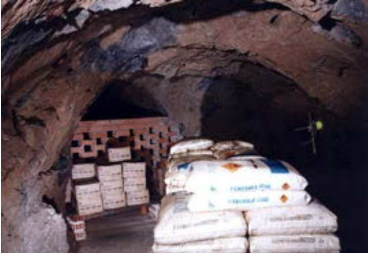
Figura 143: Entrada e interior de depósito de explosivo em subsolo
