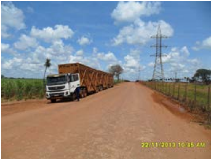
Figura 95: Uma composição de transporte de cana com três carrocerias (condição não permitida pela legislação de trânsito, que só permite para este tipo veículo duas carrocerias rebocadas)
