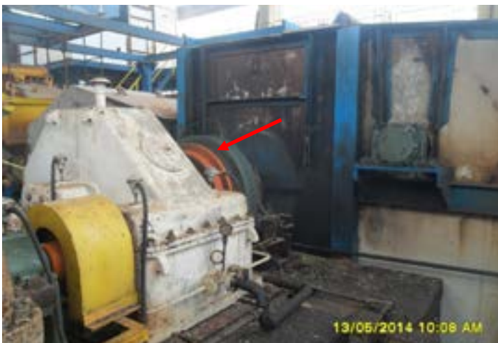
Figura 101: Picador movido a turbina (note o eixo acoplado que gira em alta rotação sem proteção ao lado)
