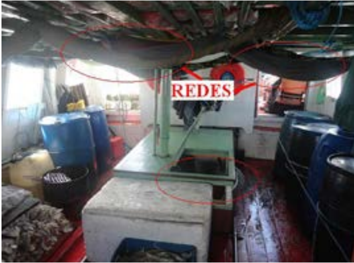
Figura 187: Redes individuais situadas em cima da abertura da casa de máquinas, por onde era expelida a fumaça dos motores; embaixo e nas laterais das redes, há ainda o armazenamento de pescado fresco e de tanques de combustível
