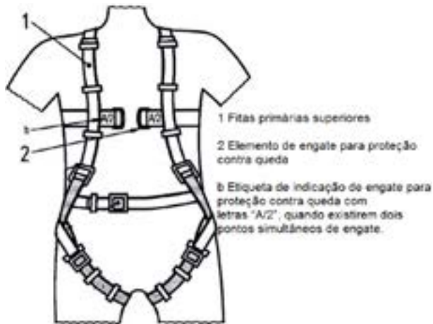
Figura 57: Dois pontos de engate simultâneos de retenção de quedas. Cada ponto é marcado com o símbolo A/2. O deve ser conectado simultaneamente aos dois pontos. Fonte: NBR 15836.
