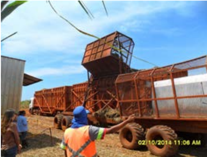
Figura 92: Balizador orientando a manobra de transferência da carga de cana para carroceria de um caminhão (observe a proximidade com a área de convivência e, por conseguinte, com outros trabalhadores não envolvidos na operação)
