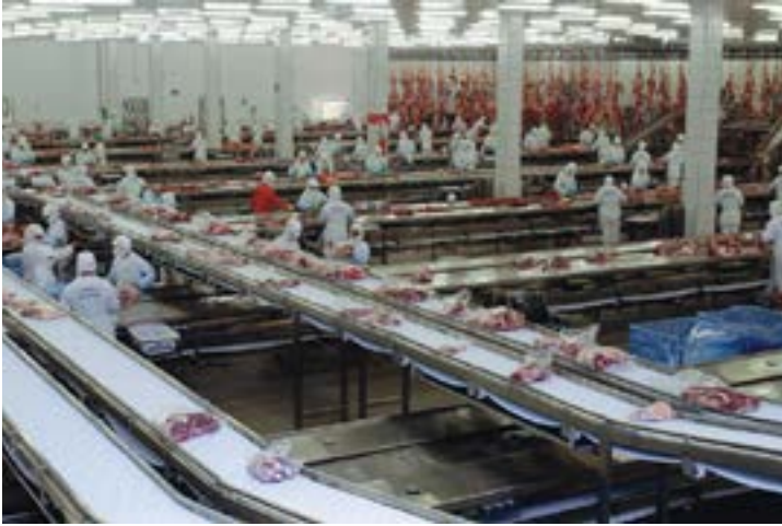
Figura 125: Uma unidade de desossa típica de um frigorífico em que se observa que o layout impõe uma série de obstáculos para uma evacuação emergencial
