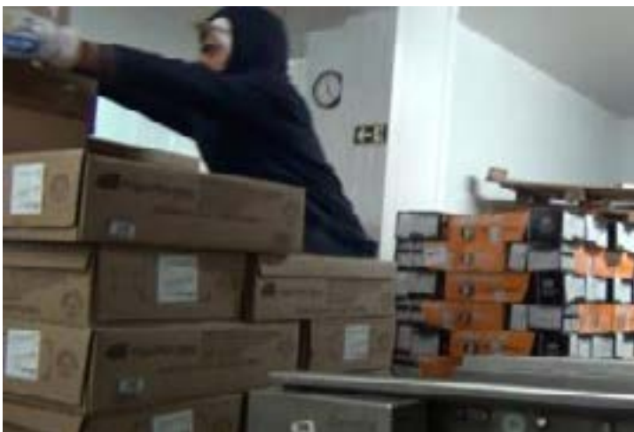
Figura 214: Atividade de paletização com distância medida de até 90 cm do corpo do trabalhador na movimentação das cargas
