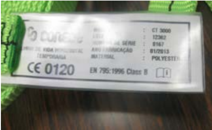
Figura 77: Produto vendido como linha de vida horizontal temporária, mas com certificação inadequada (é do tipo B, quando a linha de vida horizontal deveria ser do tipo C. Além disso, foi utilizada a norma de EN 795:1996; porém, a norma vigente é a EN 795:2012)
