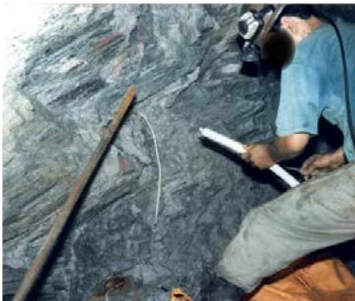
Figura 146: Trabalhador na frente de trabalho de mina subterrânea realizando furo em explosivo encartuchado para posterior escorva, tendo ao lado socador de madeira utilizado para introduzir o explosivo no furo da rocha
