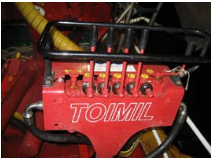
Figura 182: Alavanca de acionamento de guincho protegida
