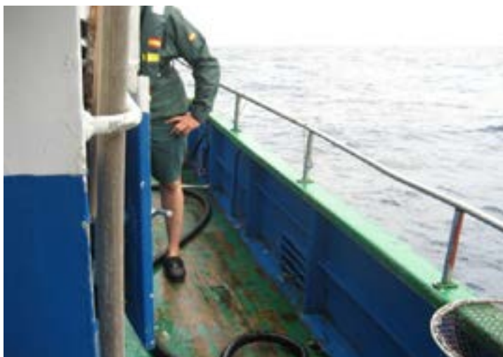
Figura 176: Amurada dotada de dispositivo para impedir quedas (Fonte: Inspeção do Trabalho da Espanha)
