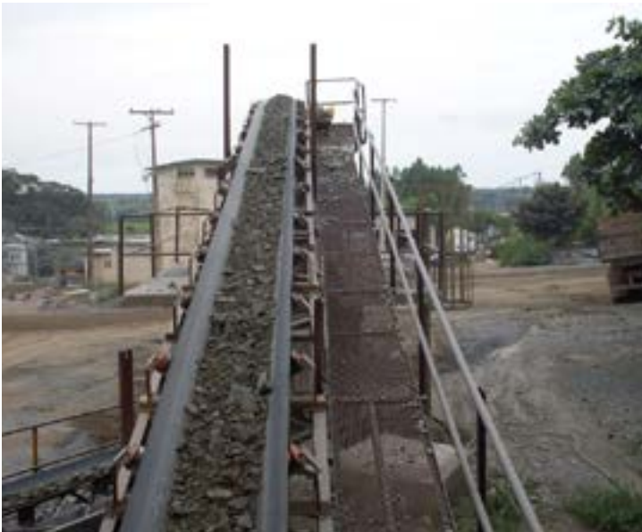
Figura 149: Partes móveis (roletes de correia transportadora) sem proteção (Arquivo do autor)
