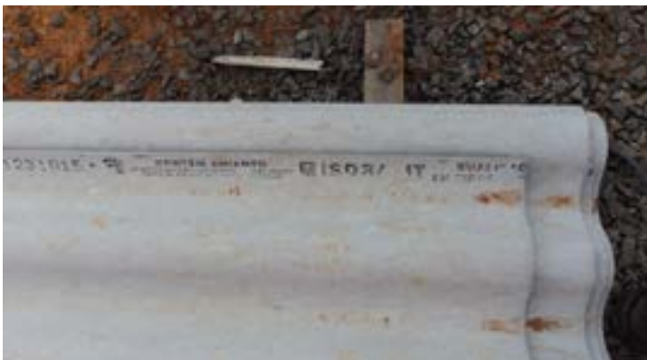
Figura 127: No Brasil, o setor de construção civil ainda utiliza massivamente artefatos de fibrocimento com amianto
