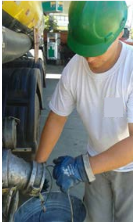
Figura 132: Vazamentos e gotejamentos provocados por falhas na manutenção e má compatibilidade entre componentes utilizados no descarregamento de derivados de petróleo potencializam a exposição à fração tóxica inalável do produto
