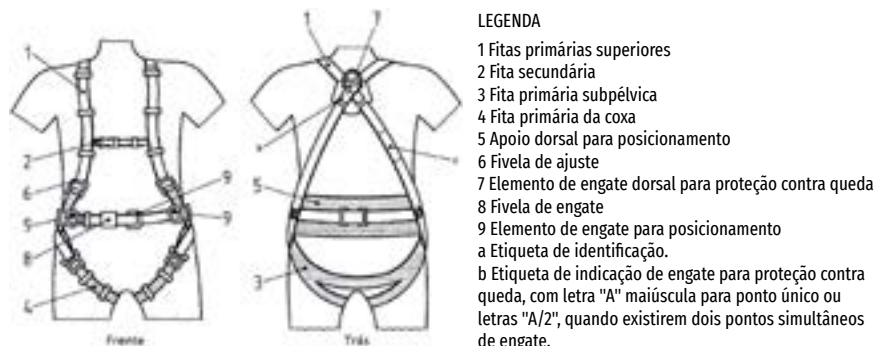
Figura 55: Exemplo de cinturão de segurança tipo paraquedista. Fonte: NBR 15836
