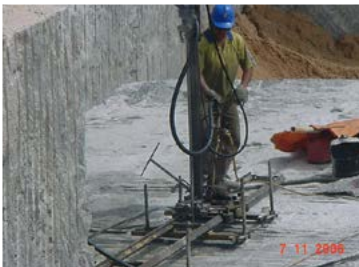
Figura 165: Equipamento corta-bloco com umidificação (Arquivo do autor)
