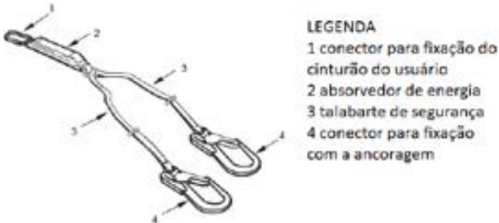
Figura 58: Talabarte em Y com absorvedor de energia integrado. Fonte: P-NBR 16489
