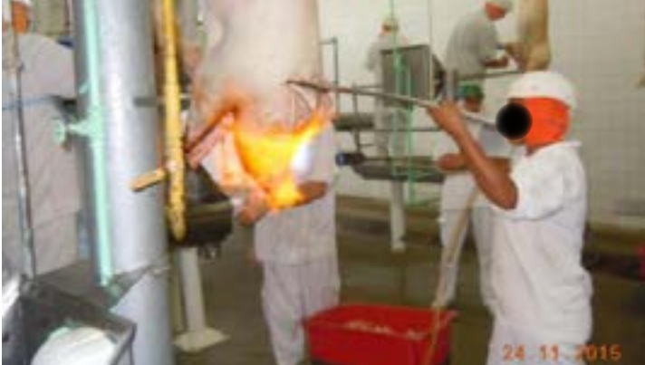
Figura 223: Nessa atividade, são exigidas posturas extremas de punho, cotovelo e braço; os equipamentos utilizados (maçarico e ferramenta de apoio) são segurados sem qualquer balancim de sustentação, gerando uma sobrecarga estática nos membros superiores da trabalhadora durante todo o tempo de execução da tarefa
