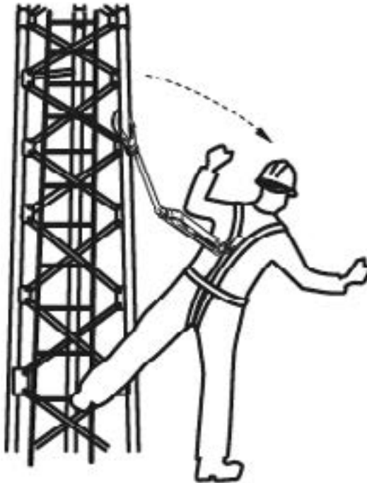
Figura 62: Sistema de ancoragem composto unicamente pela estrutura
