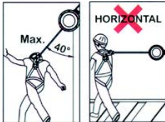
Figura 89: Trava-quedas retráteis devem respeitar os limites de uso previstos no manual de instruções, como ângulo máximo em relação à vertical
