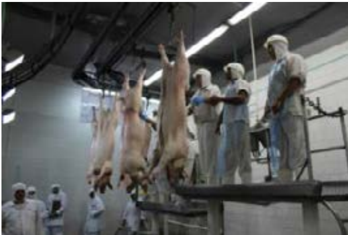
Figura 226: Atividades realizadas em plataformas elevadas, sem sistemas de proteção coletiva contra queda, em ambiente úmido e escorregadio
