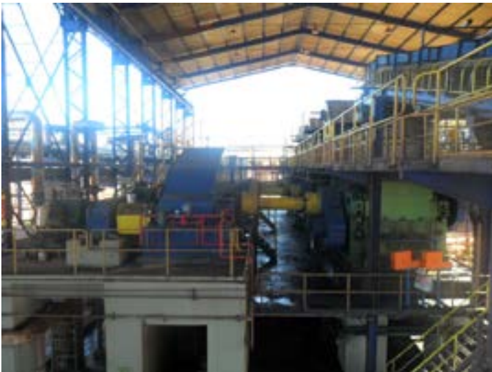
Figura 97: Uma linha de moenda típica com utilização de turbina a vapor
