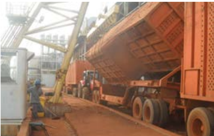
Figura 99: Operação de tombamento da carroceria na mesa alimentadora
