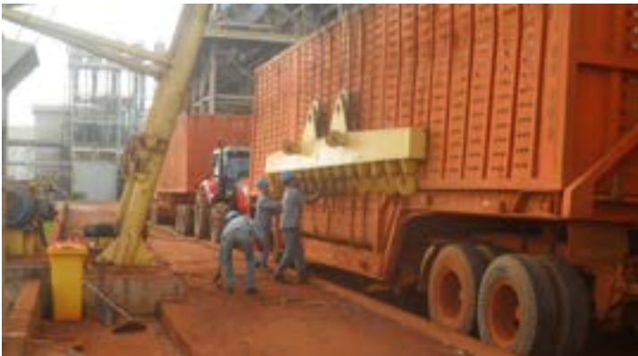
Figura 98: Operação de acoplamento/desacoplamento de carrocerias de caminhão canavieiro
