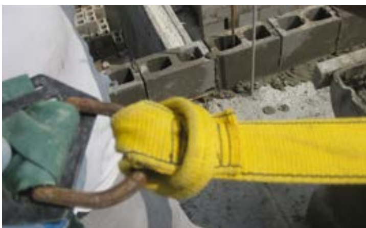
Figuras 80 e 81: Talabarte sem absorvedor de energia
