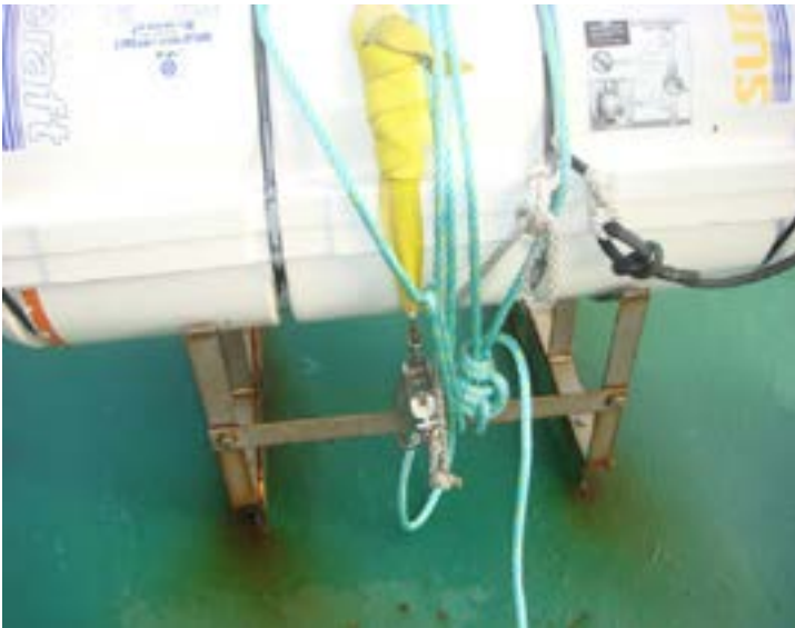
Figura 174: Balsa salva-vidas (uso incorreto por estar amarrada, impedindo o funcionamento do dispositivo hidrostático)
